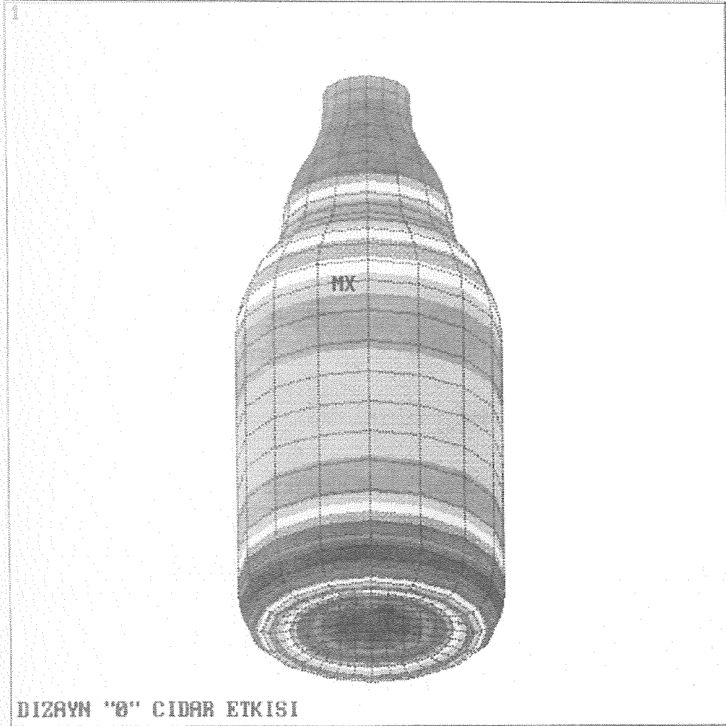
Şekil 6. İç basınç (1 MPa) sonucu oluşan çevresel (hoop) stresler.
